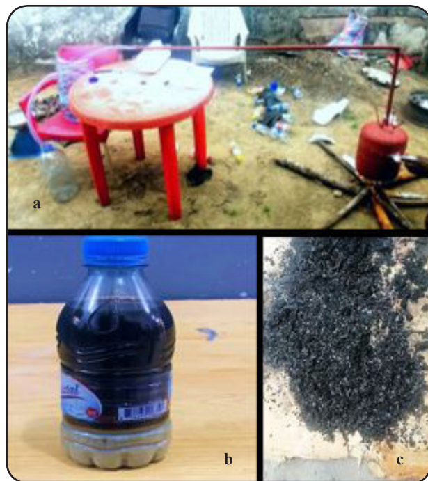
Fig. 3. (a) Pyrolysis setup, (d) Pyrolytic oil, (c) Carbon black (char).
